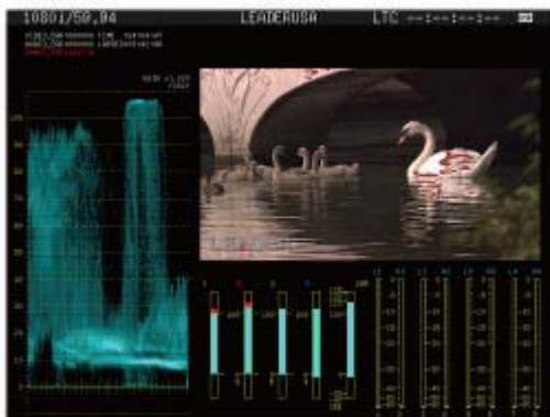
La captura de pantalla muestra la imagen, forma de onda, 5-barras y barras de audio en una combinación multi-pantalla
