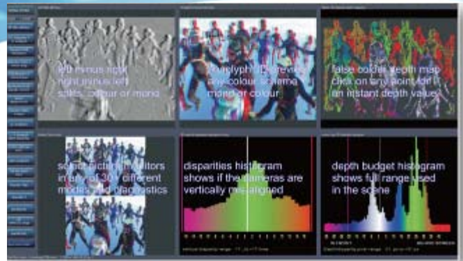
Arriba: Disposición típica del display con profundidad y disparidades identificadas en colores falsos
